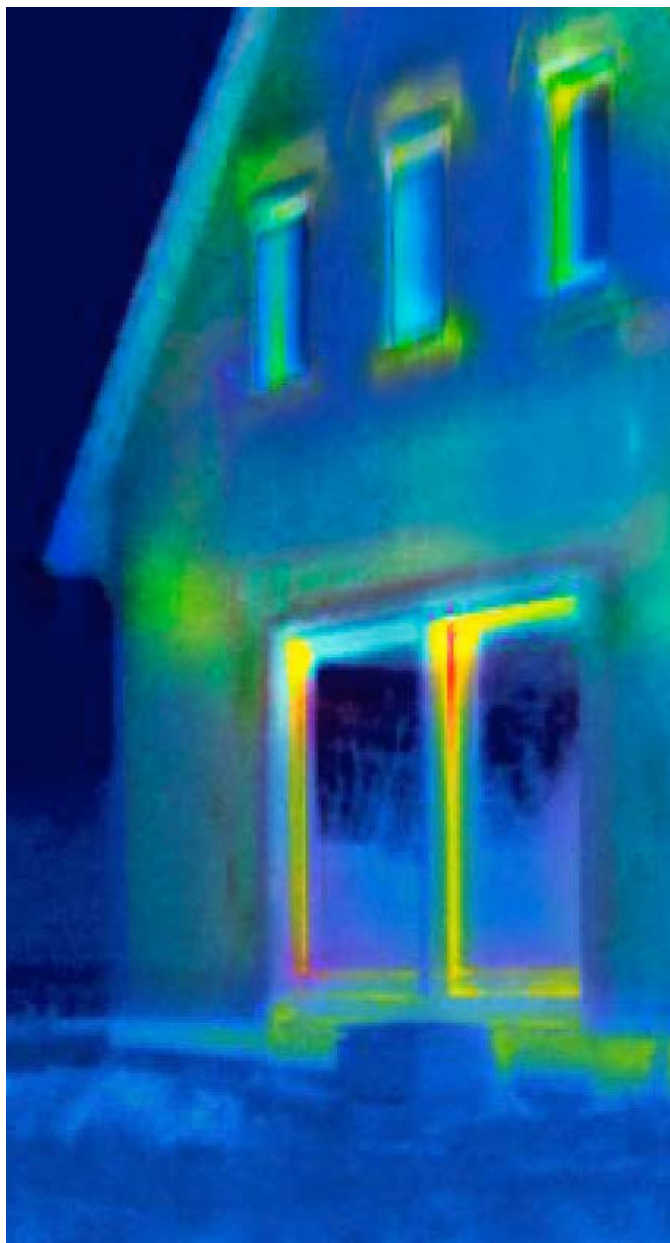
Pre renoviranja: na slici su crvenom bojom prikazani veliki gubici toplote.
